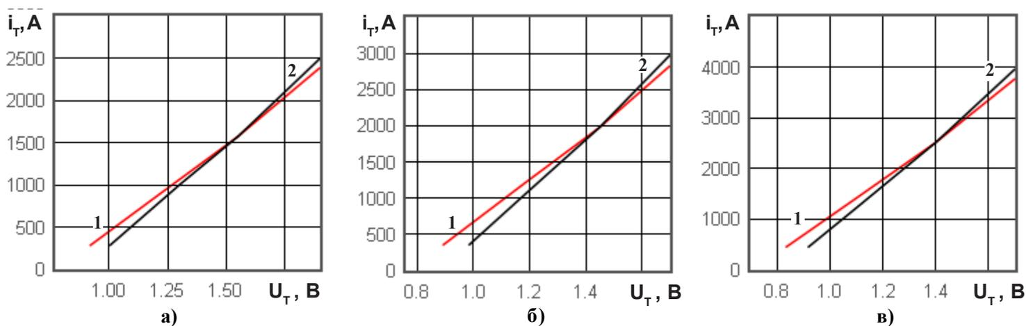
Рисунок 1: Предельные вольтамперные характеристики при максимально допустимой температуре перехода  $T_{jm}$  (1) и температуре  $T_j = 25\text{ }^\circ\text{C}$  (2),  $I_T = 3,14I_{T(AV)}$ , для модулей:
