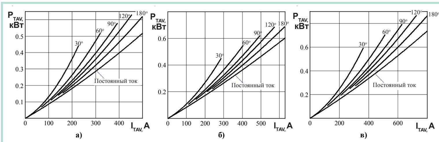
Рисунок 7 - Зависимость средней рассеиваемой мощности в открытом состоянии  $P_{TAV}$  от среднего тока в открытом состоянии прямоугольной формы частотой 50 Гц при различных углах проводимости и постоянного тока  $I_{TAV}$  для модулей:
