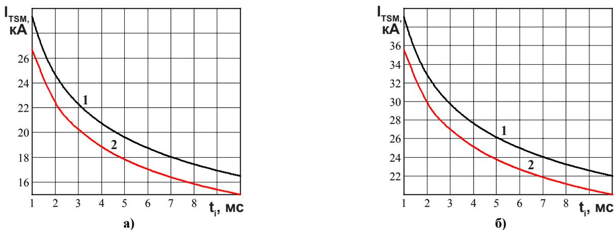
Рисунок 4 - Зависимость допустимой амплитуды ударного тока в открытом состоянии  $I_{TSM}$  от длительности импульса тока  $t_i$  при исходной температуре структуры  $T_j = 25^\circ\text{C}$  (1) и максимально допустимой температуре перехода  $T_{jm}$  (2) для модулей:
