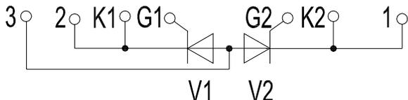
V1 - первый полупроводниковый элемент модуля
