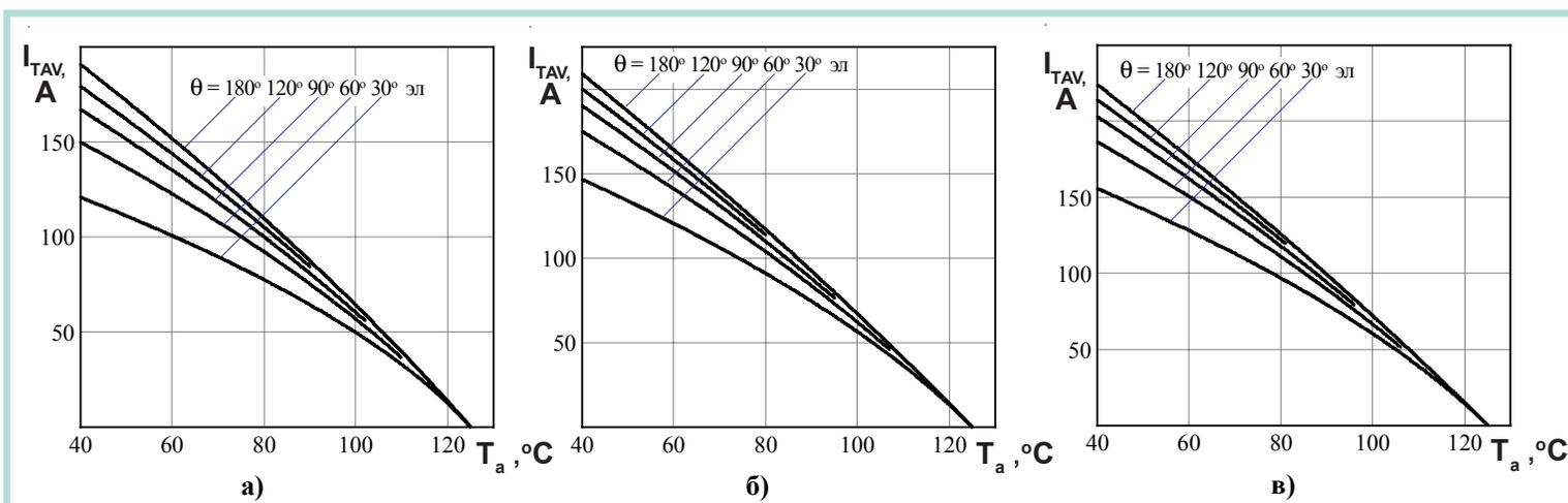
Рисунок 8 - Зависимость допустимого среднего тока в открытом состоянии синусоидальной формы  $I_{TAV}$  частотой 50 Гц при различных углах проводимости от температуры окружающей среды  $T_a$  при естественном охлаждении на охладителе ОР564-300 для модулей:
