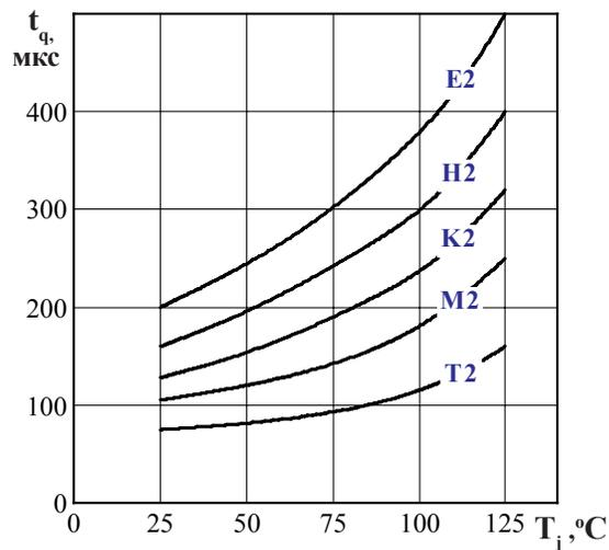
Рисунок 11 - Зависимость времени выключения  $t_q$  от температуры структуры  $T_j$  при  $I_T = I_{TAVM}$ ;  $U_D = 0,67 U_{DRM}$ ;  $U_R = 100\text{ В}$ ;  $(di/dt)_f = 5\text{ А/мкс}$ ;  $dU_D/dt = 50\text{ В/мкс}$
