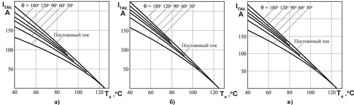
Рисунок 9 - Зависимость допустимого среднего тока в открытом состоянии прямоугольной формы частотой 50 Гц при различных углах проводимости и постоянного тока  $I_{TAV}$  от температуры окружающей среды  $T_a$  при естественном охлаждении на охлаждающем ОР564-300 для модулей:
