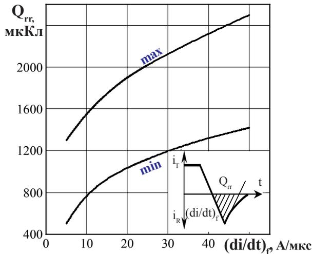
Рисунок 10 - Зависимость заряда восстановления  $Q_{rr}$  от скорости спада тока  $(di/dt)_f$  в открытом состоянии при  $T_{jm} = 125\text{ }^{\circ}\text{C}$ ;  $U_R = 100\text{ В}$ ;  $I_T = I_{TAVM}$ .
