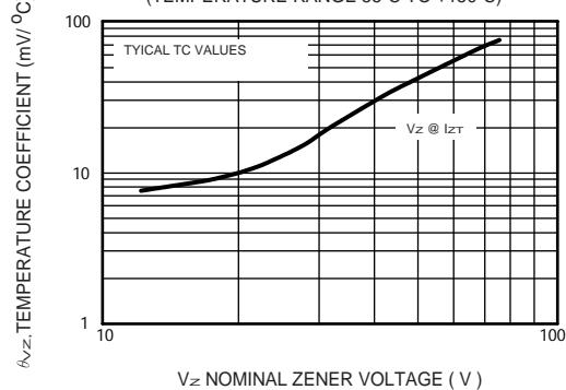
FIG. 3 - EFFECT OF ZENER VOLTAGE ON
