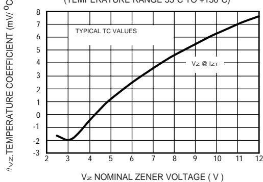
FIG. 2 - TEMPERATURE COEFFICIENTS)
