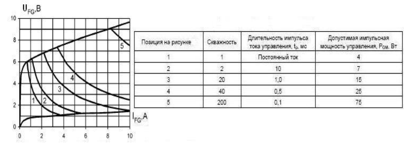
Рисунок 15: Предельные характеристики цепи управления.
