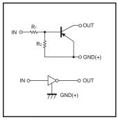
$R_1=2.2k\Omega / R_2=10k\Omega$
