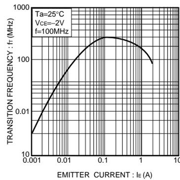
Fig.5 利特帯域幅積 - エミッタ電流特性
