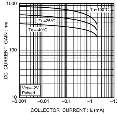
Fig.2 直流電流増幅率 - コレクタ電流特性
