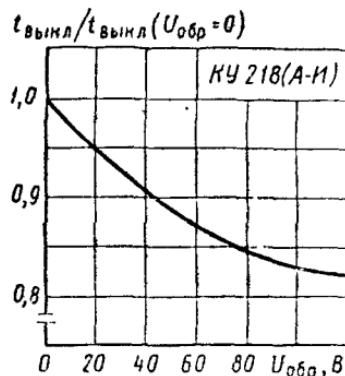
Зависимость времени выключения от напряжения
