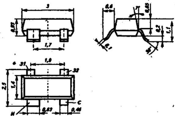
Транзистор кремниевый эпитаксиально-планарный структуры *p-p-n*. Предназначен для применения в качестве малошумящего усилительного элемента в селекторах, тюнерах и других радиотехнических устройствах. Выпускается в пластмассовом корпусе с гибкими выводами, тип корпуса КТ-48. Масса транзистора не более 0,1 г.
